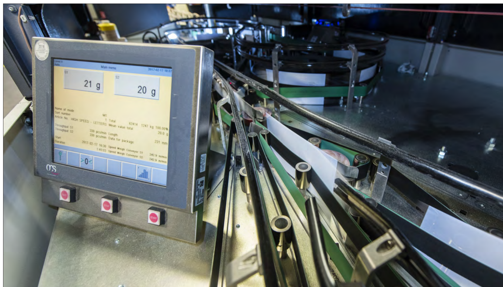
Vollautomatisches, hochpräzises Wiegen der Briefe.
