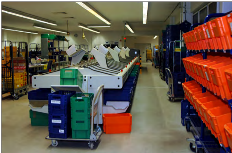
Die Sortiermaschine „Vantage Single Tier“ schafft bis zu 40.000 Briefe in der Stunde.
